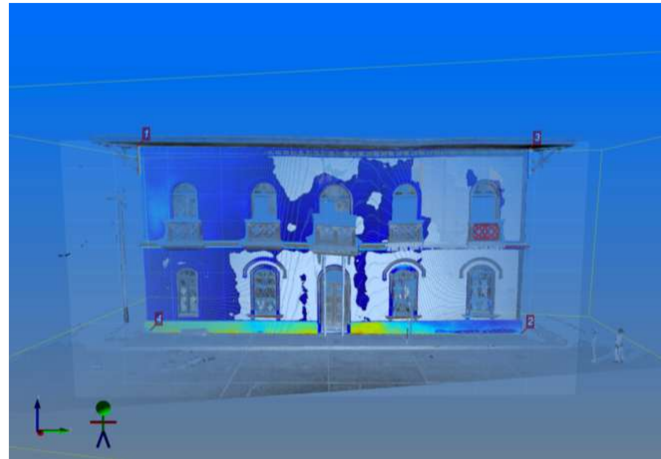
Análisis de deformaciones en Fachada de la Ex Aduana de Paita
